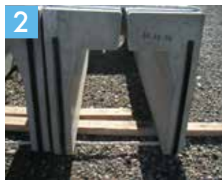
製品本体に止水パッキンの貼付
